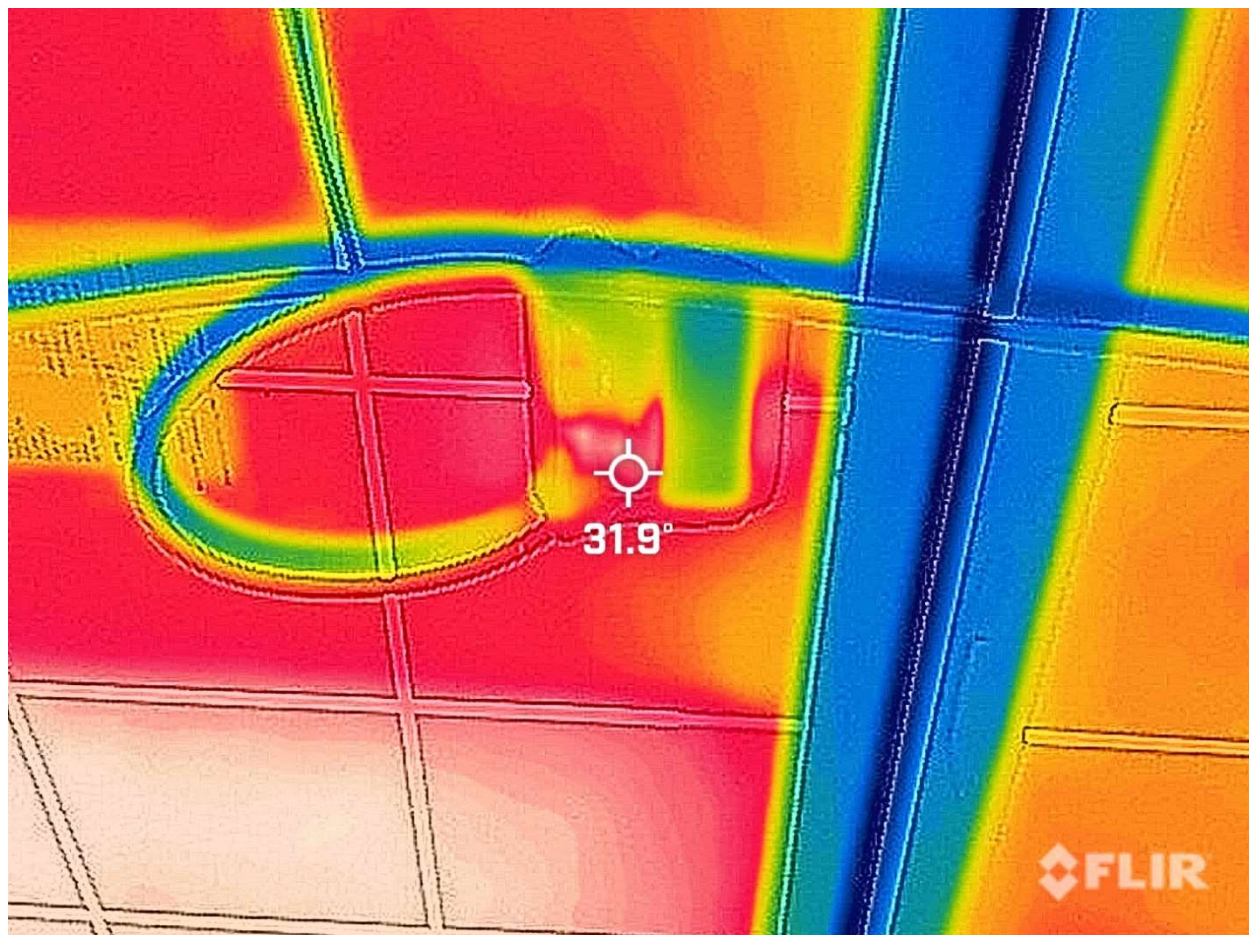
リマテック太陽光発電所(岡山) クラスタ落ちパネル測定写真(2023年3月～4月)
