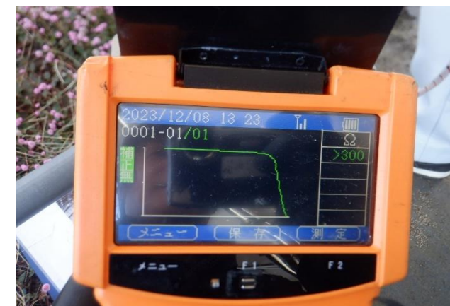
出力低下モジュール6 IVH測定
