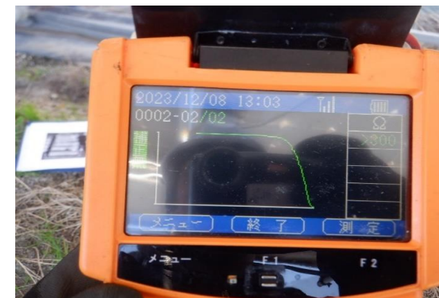
出力低下モジュール2 IVH測定
